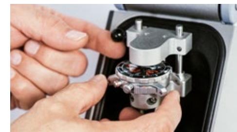
Teil der Endkontrolle: Die Überprüfung der Wasserdichtheit Part of the final inspection: the water resistance check
